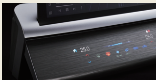
自動車内装向けユーザーインターフェース (光を透過する木目意匠の成形品)
